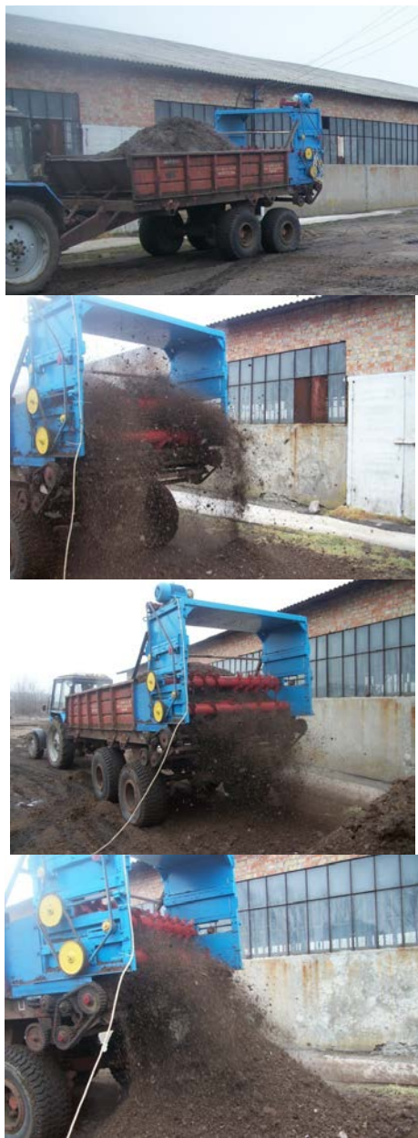
Рис. 3. Процес механічної аерації і змішування гноє-компостної суміші на експериментальній установці на базі причіпного розкидача добрив ПРТ-10 із двобарабанним навісним пристроєм.
