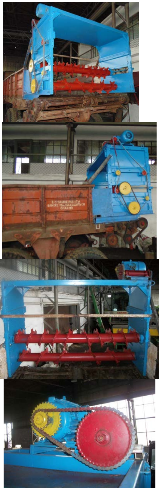
Рис. 1. Загальний вигляд експериментальної установки на базі причіпного розкидача добрив ПРТ-10 із двобарабанним навісним пристроєм для подрібнення твердих органічних добрив.
