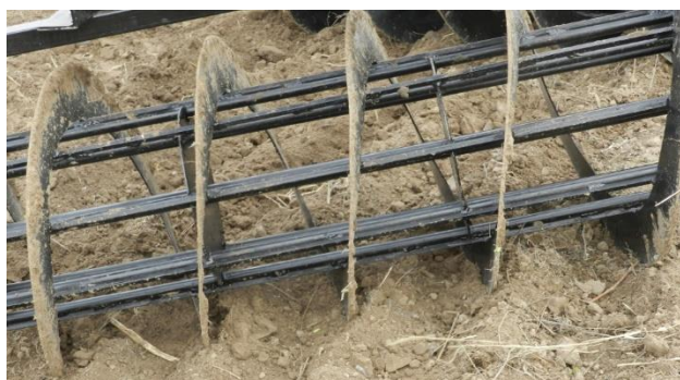
Рис. 1. Загальний вигляд гвинтового робочого органу.
