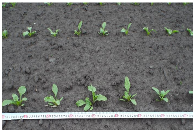
Рис. 7. Вимірювання відхилення дійсного положення висіяного насіння вздовж рядка.
