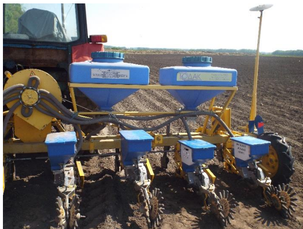
Рис. 1. Загальний вигляд МТА (трактор МТЗ-82.1 + сівалка СТВТ-12/8М) для проведення досліджень.
