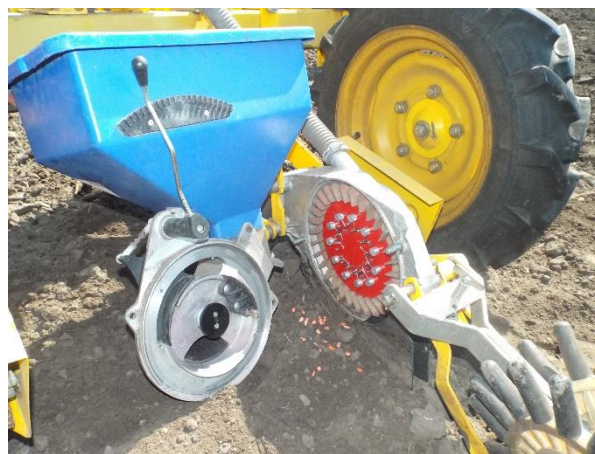
Рис. 2. Дослідний висівний апарат з дозатором направленої дії.
