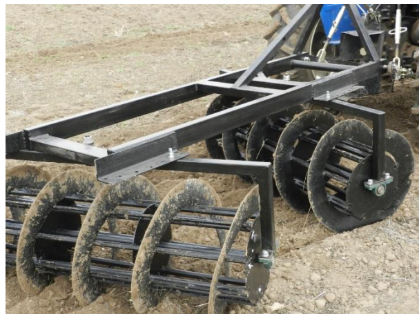
Рис. 2. Загальний вигляд експериментального зразка борони з гвинтовими робочими органами.
