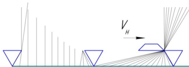
Рис. 2. Процес різання вовни різальною парою з обертним характером руху ножа.
