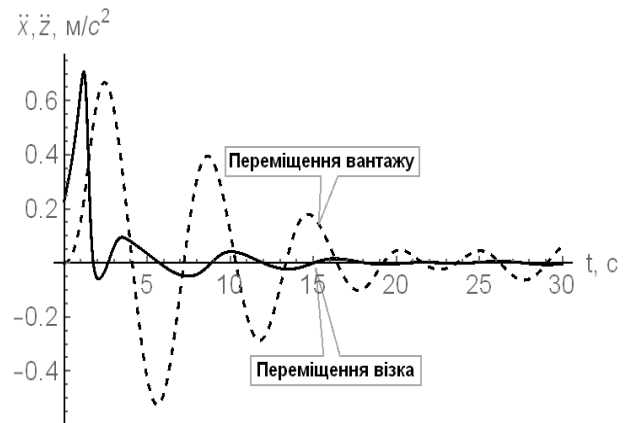
Рис. 3. Графіки прискорення вантажу \ddot{x} та візка \ddot{z} при зміні вильоту вздовж стріли.
