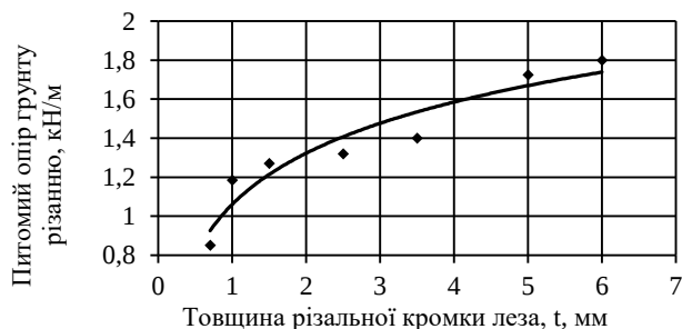
Рис. 2. Залежність питомого опору ґрунту різанню від товщини різальної кромки леза.
