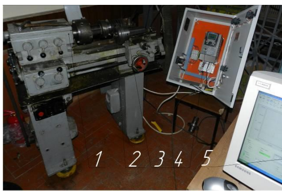
Рис. 8. Загальний вигляд стандового обладнання: 1 – верстат; 2 – ГЗ; 3 – формувальний інструмент; 4 – Altivar; 5 – ПК
