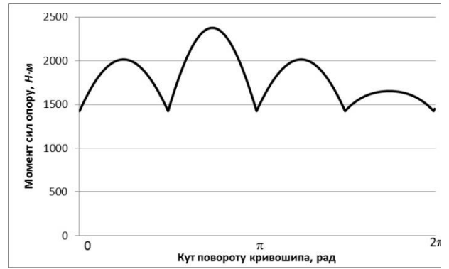
Рис. 2. Графік зміни моменту сил опору на переміщення формувальних візків в залежності від кута повороту кривошипа.
