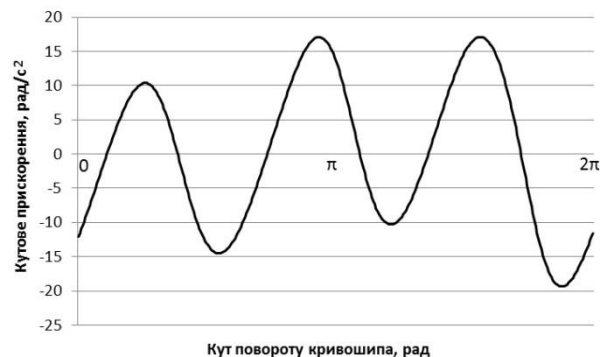
Рис. 7. Графік зміни кутового прискорення кривошипа установки в залежності від кута його повороту на усталеному режимі руху.
