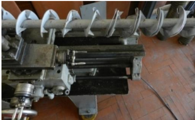
Рис. 3. Виготовлення ГЗВП з використанням шнекової оправи. Fig. 3. SBCP manufacturing with screw mandrel using.
