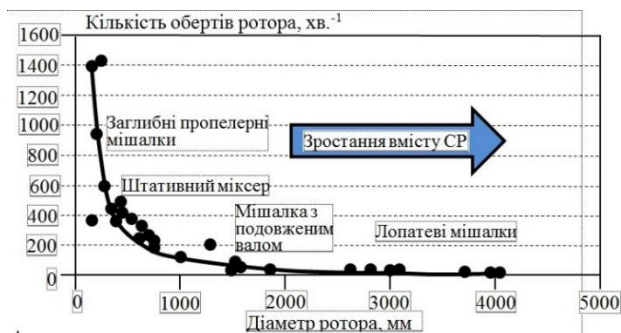
Рис. 5. Графік залежності кількості оборотів ротора від діаметру різних видів мішалок та зростання вмісту СР.
