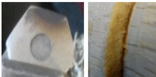
Рис. 7. Зміна температури поверхні різця та заготовки при обробленні в екстремальних режимах.
