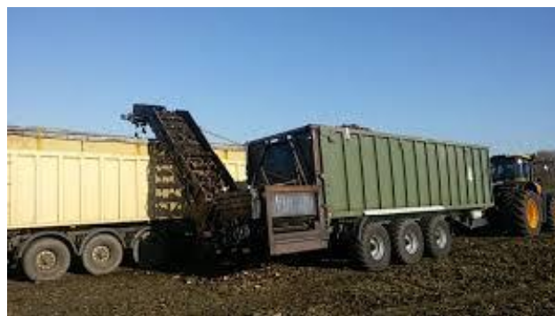
Рис. 1. Буряки, які вивезені з поля, на дорозі перевантажуються «Атлантом» у великовантажні АТЗ для перевезення на цукровий завод.
