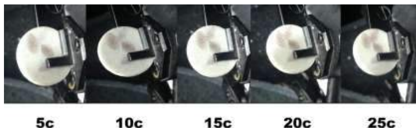
Рис. 3. Зображення поверхні зразка композиту «МКЦ+AgNO 3 » після лазерного опромінення (тривалість опромінення зазначено на рисунку)
