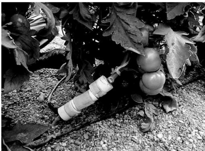
Рис. 3. Датчик водяного потоку, встановлений на стеблі
