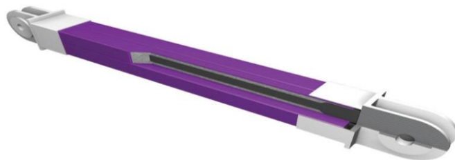
Рис. 9. В'язь від повздовжнього згину (Buckling restrained brace).
