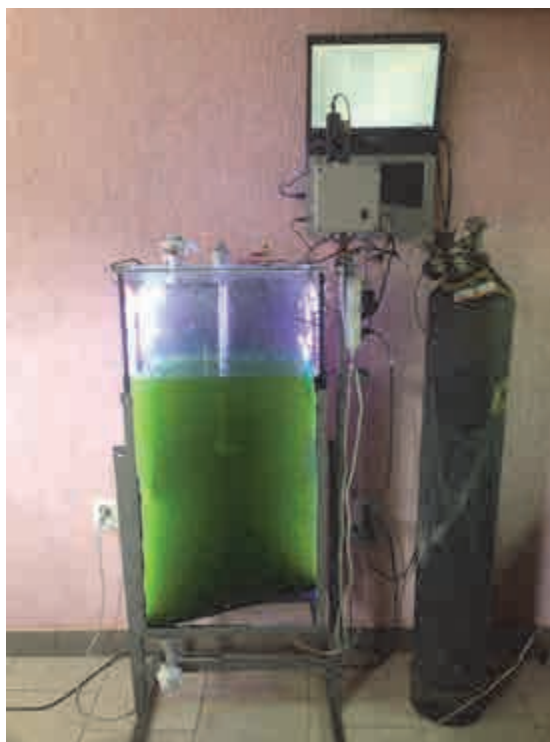
Рис. 4. Лабораторна установка біотехнологічного комплексу на базі фотобіореактора
