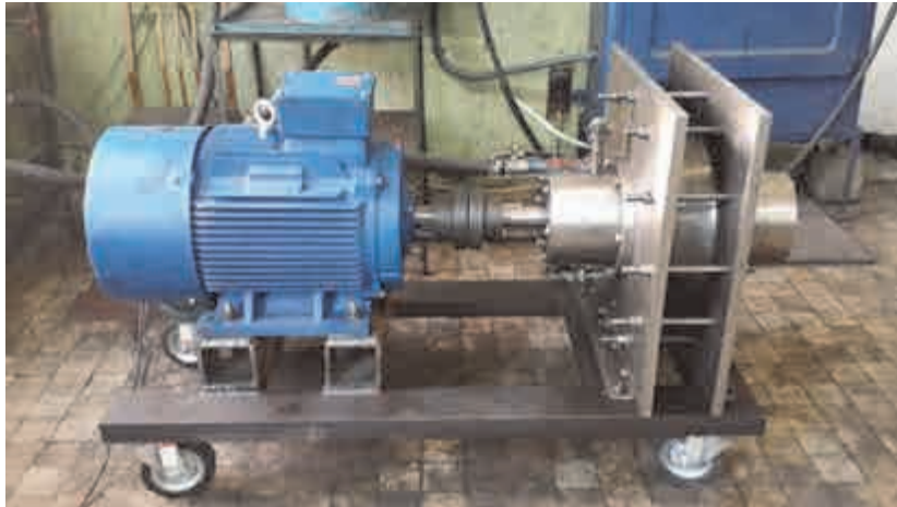
Рис. 1. Загальний вигляд теплогенератора РТГА-37
