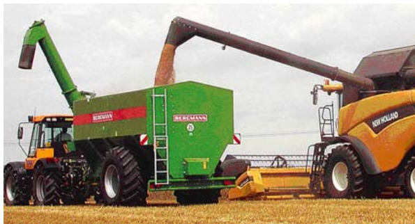
Рис. 2. Розвантаження зерна в ПП з бункера комбайна в ПП.
