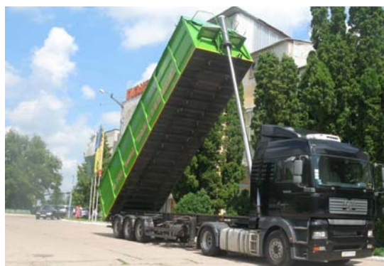
Рис. 7. Автомобільний напівпричіп-самоскид НПС 2150 (Україна) з автотягачем.
