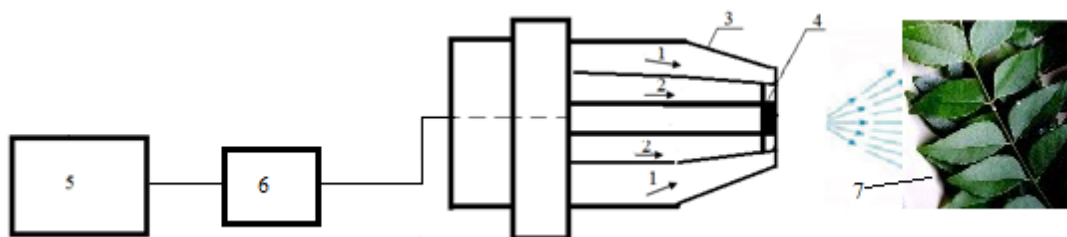
Рис. 2. Принципова схема розпилення: 1 – потік повітря; 2 – робочий розчин; 3 – корпус розпилювача; 4 – зарядний високовольтний електрод; 5 – джерело високої напруги; 6 – інвертор; 7 – об'єкт нанесення
