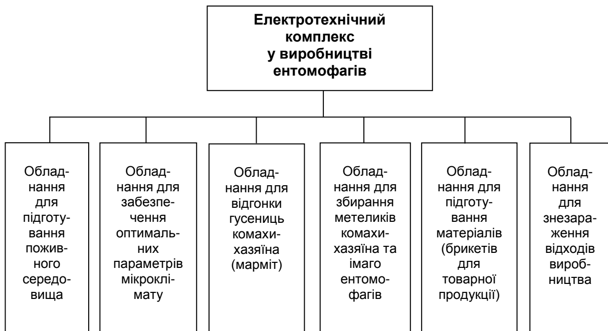
Рис. 2. Структура електротехнічного комплексу у виробництві ентомофагів
