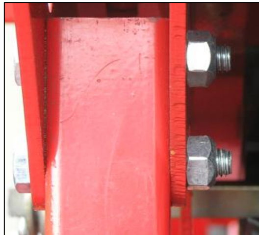
Рис. 4. Вихід стрижня болта за межі гайки (відповідає нормованим вимогам).
