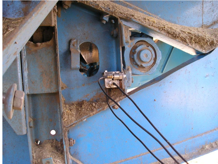
Рис. 1. Вимірювання вібрації різьбового з'єднання техніки.
