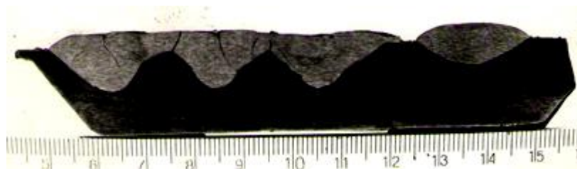
Рис. 11. Геометричні параметри точок зміцнення.
