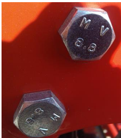
Рис. 1. Клас міцності болтів на сівалках випуску 2013 року.
