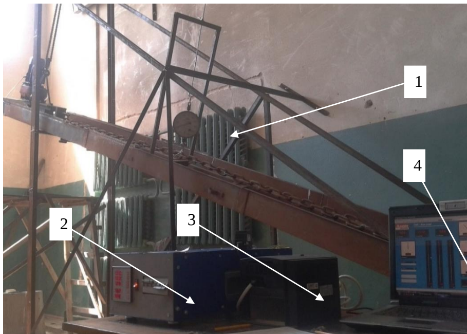
Рис. 1. Загальний вигляд експериментальної установки: 1 – динамометр ДПУ-0,5-2; 2 – кіловатметр Lovato elektrik DMK 40; 3 – частотний перетворювач OMRON HITACHI JX INVERTER 7,5 kW; 4 – персональний комп'ютер з програмним продуктом DMK Remote Control.
