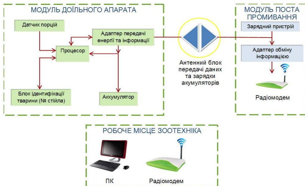
Рис. 5. Структурно-технологічна схема АСУТП для ферм з доїнням корів у стійловий молокопровід.
