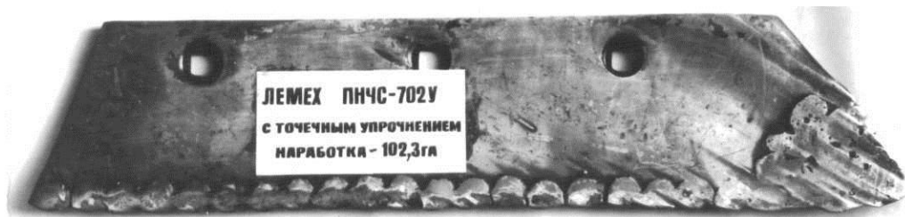
Рис. 3. Леміш з точковим зміцненням після наробітку 102,3 га.
