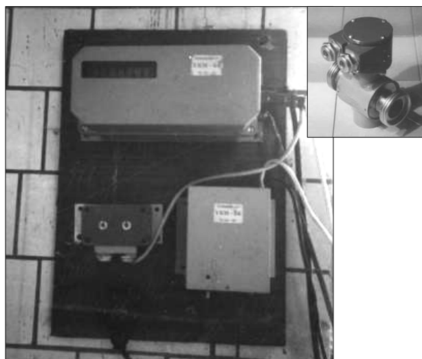
Рис. 5. Устройство для дифференцированного учёта молока УКМ-Бк
