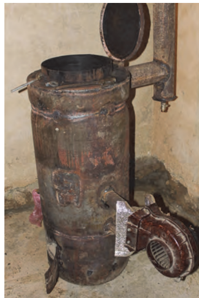
Рис. 2. Дослідний зразок газогенераторного котла
