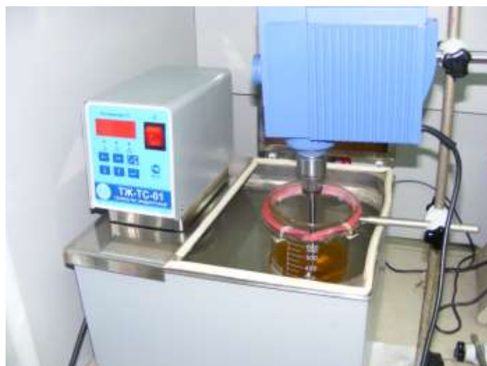
Рис. 3. Лабораторна установка для визначення впливу параметрів мішалки на лужність дизельного біопалива.
