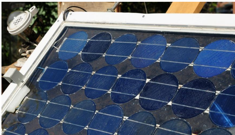
Рис.3. Внешний вид разработанного макета ФЭТ модуля
