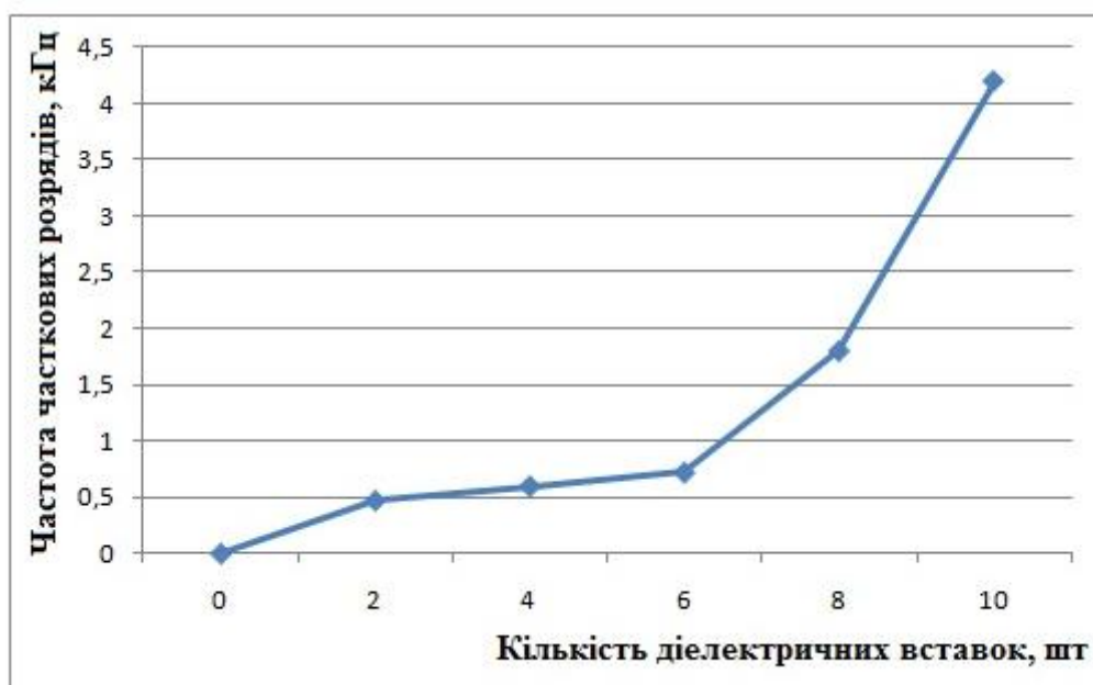
Рис. 3. Залежність частоти часткових розрядів від кількості діелектричних електродів
