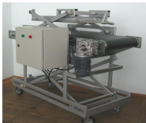
Рис. 6. Електротехнологічний комплекс магнітної обробки сільськогосподарської продукції
