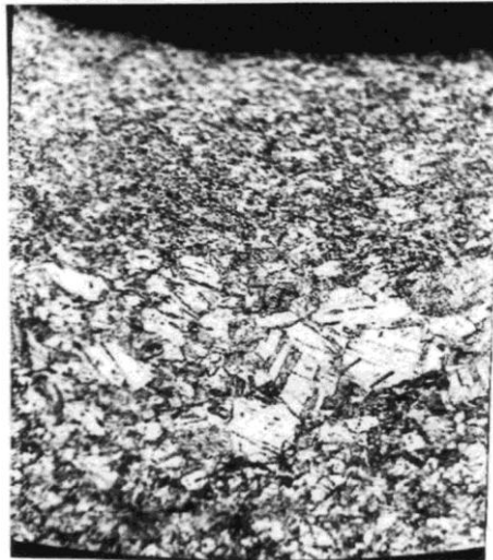
Рис.5. Мікроструктура анода контакту з матеріалу SrM-0,2 після 1 \times 10^5 комутацій (збільшено \times 200 )
