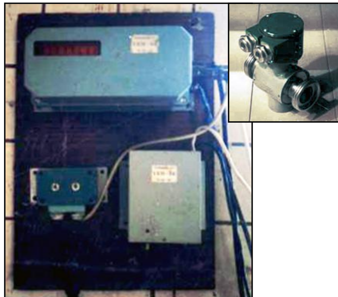
Рис. 3. Устройство для дифференциального учета потока молока (УКМ-Бк)
