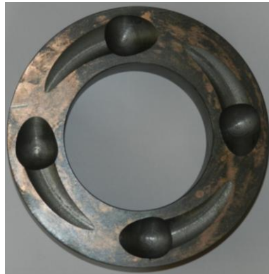
Рис. 2. Конструктивна схема (а), загальний вигляд (б) запобіжного пристрою та загальний вигляд (в) робочої поверхні ведучої півмуфти
