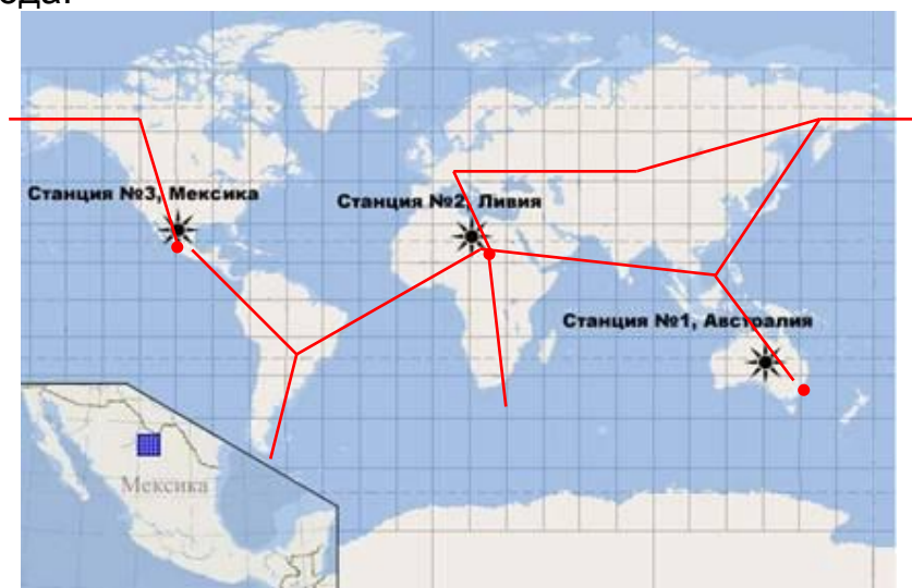
Рис. 1. Глобальная солнечная энергетическая система из трех солнечных электростанций (на карте Мексики в масштабе показаны размеры солнечной электростанции)
