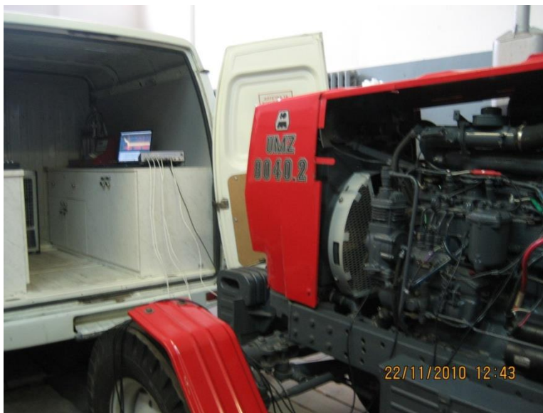
Рис. 6. Пересувна діагностична лабораторія.
