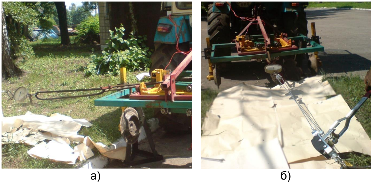
Рис. 4. Тарування рам, що сприймають бокову(а) та поздовжню(б) складову результуючої сили опору.
