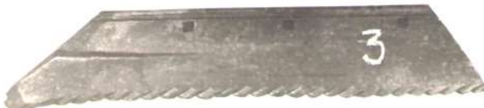
Рис. 8. Леміш плуга після наробітку 49 га.
