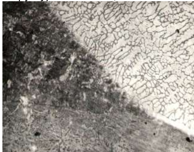
Рис. 11. Лінія сплавлення з верхнім і середнім шаром, \times 250 .
