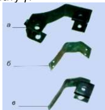
Рис. 2. Типи досліджуваних дек: а – дека ( \gamma=45^\circ ), б – дека ( \gamma=25^\circ ), в – дека ( \gamma=10^\circ ).
