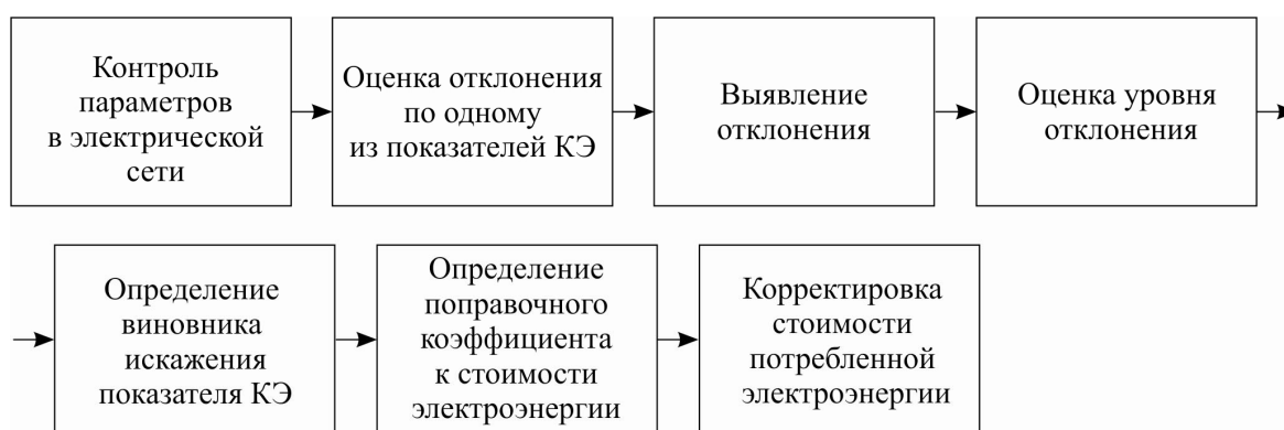
Рис. 7. Блок-схема функционального блока определения стоимости потребленной электроэнергии в зависимости от её качества
