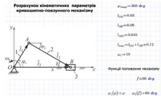
Рис. 3. Вхідні параметри для розрахунку кінематичних параметрів аксіального кривошипно-повзунного механізму.
