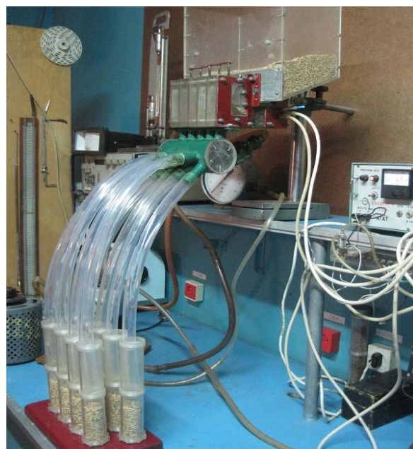
Рис. 1. Загальний вигляд висівних пристроїв на основі пневмоструминних елементів (джерело: розроблено авторами).
