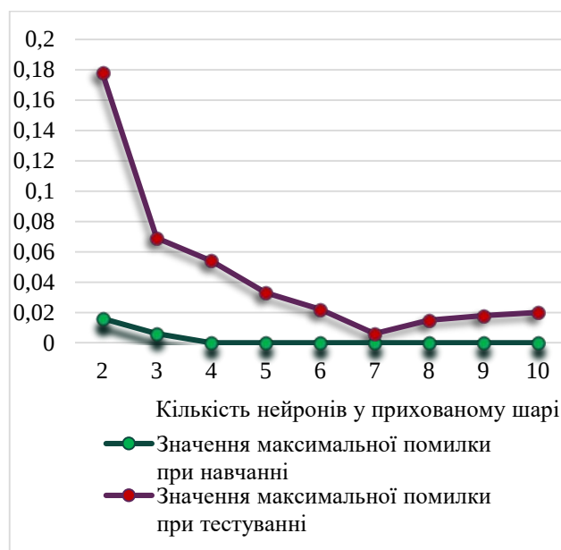
Рис. 3. Графік збіжності значень максимальної помилки розпізнавання дефектів ЦПГ при навчанні і тестуванні ШНМ.
