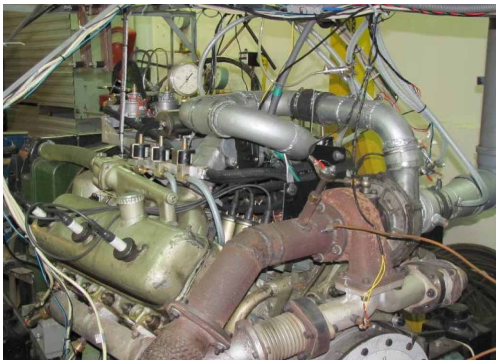
Рис. 1. Зовнішній вигляд газового двигуна 6ГЧН 13/14 з елементами системи управління розподільної подачі газу.
