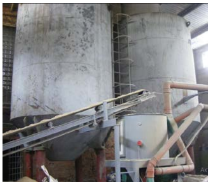
Рис. 4. Накопичувальні бункери сировини після попереднього дроблення.
