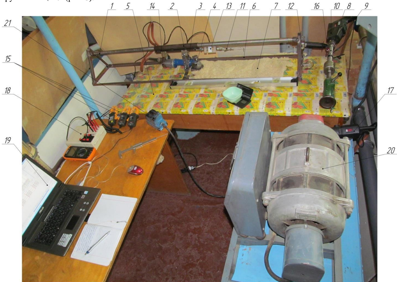
Рис. 5. Загальний вигляд стенда для випробування ручних різальних інструментів: 1 – рама, 2 – візок, 3 – тримач, 4 – стригальна машинка, 5 – стіл, 6 – тримач овчини, 7 – овчина (штучна вовна), 8 – привідний барабан (вісь), 9 – трос, 10 – привід, 11 – роз’єднувач, 12 – стопор, 13 – тензометричний датчик, 14 – датчик Холла, 15 – струмові кліщі, 16 – датчик обертів, 17 – електромережа 220В, 18 – аналогово-цифровий перетворювач, 19 – ПК з програмним забезпеченням, 20 – частотний перетворювач, 21 – механічний пускач приводу стригальної машинки.
