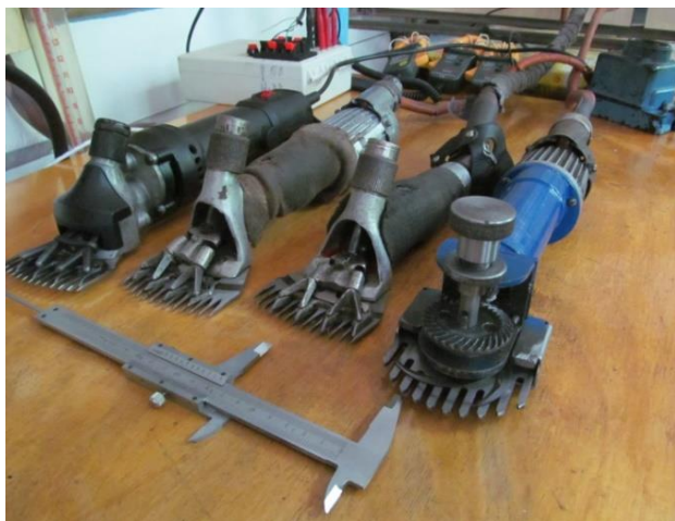
Рис. 3. Досліджувані стригальні машинки: N1J-GM01-76, МСУ-200, МСО-77В та стригальна машинка ротаційного типу.
