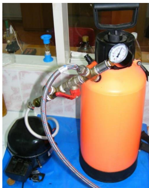
Рис. 5. Гідралічний насос на основі садового обприскувача і компресора від холодильника.
