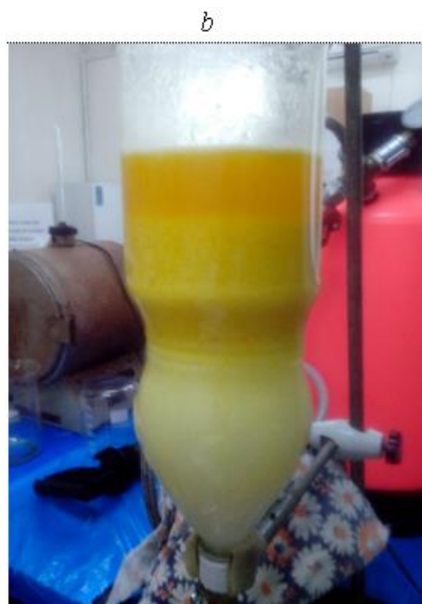
Рис. 7. Процес розшарування при аерозольному промиванні МЕЖК: a – початок; b – закінчення.
