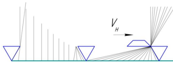
Рис. 2. Процес різання вовни різальною парою з обертотворним характером рухом ножа.
