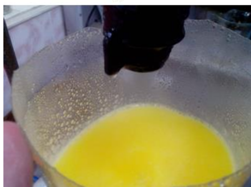
Рис. 6. Дослідження аерозольного промивання МЕЖК: a – суміш МЕЖК з водою; b – процес розпилювання води над шаром МЕЖК.
