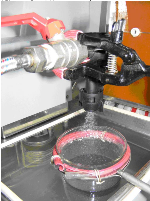
Рис. 11. Розпилення водного розчину 1% лимонної кислоти в досліджуваний зразок МЕЖК.
