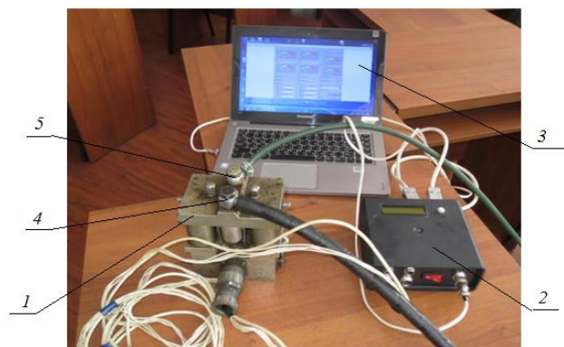
Рис. 2. Зовнішній вигляд вимірювального комплексу для визначення витрати палива: 1 – датчик витрати палива; 2 – електронний блок комутації; 3 – блок індикації та керування; 4 – впускний отвір; 5 – випускний отвір.
