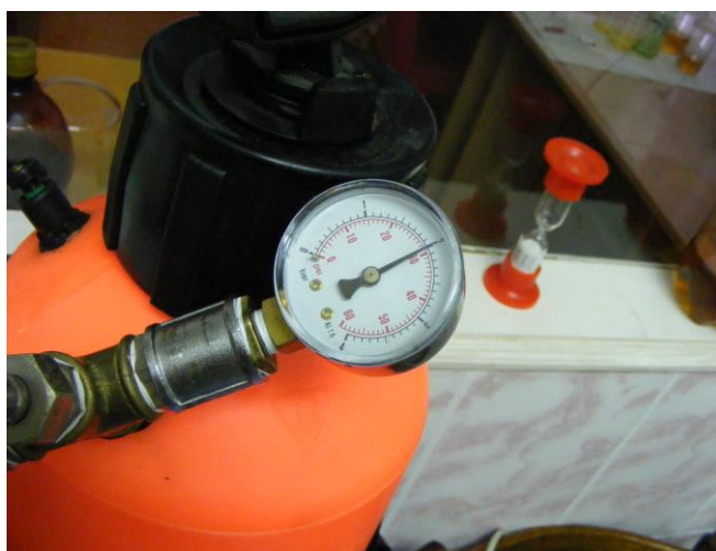
Рис. 9. Індикація тиску 1% водного розчину лимонної кислоти при її розпилюванні в досліджуваний зразок МЕЖК.
