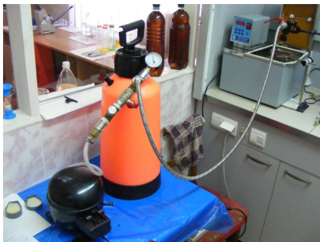
Рис. 8. Експериментальна установка для визначення впливу параметрів розпилювача на лужність МЕЖК.
