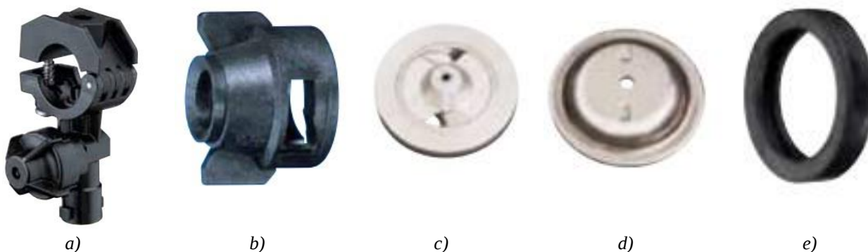
Рис. 10. Відцентровий повноконусний розпилювач "Disc and Core" [66]: 1 – корпус з одною насадкою QJ17560A-NJB; 2 – байонетний ковпачок CP 26277-1-NY; 3 – сердечник-турбулізатор DC-CER; 4 – диск з отвором керамічний DCER-2; 5 – гумовий ущільнювач CP-18999.
