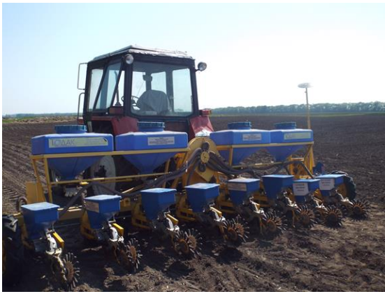
Рис. 3. Посівний МТА: трактор МТЗ-82.1 та сівалка СТВТ-12/8М.
