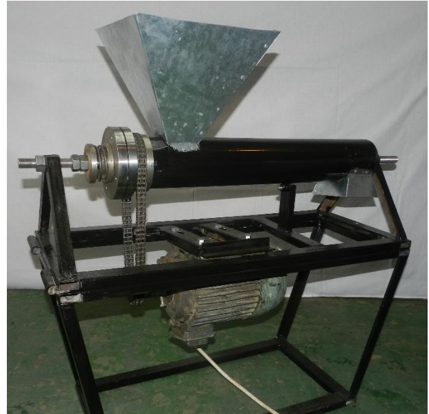
Рис. 2. Загальний вигляд експериментального стенду для дослідження запобіжної муфти.
