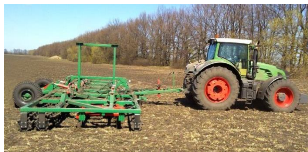
Рис. 3. Культиватор КВАНТ-12, укомплектований зміцненими культиваторними лапами
