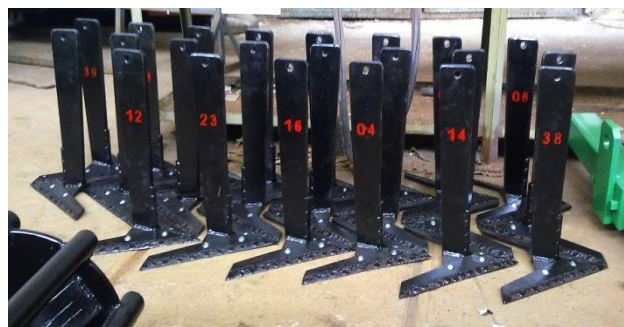
Рис. 2. Загальний вигляд зміцнених культиваторних лап за розробленою технологією
