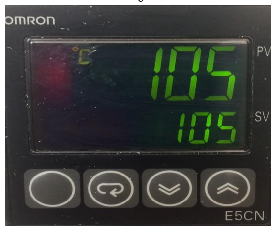
а) – загальний вигляд муфельної печі; б) – температура висушування при вимірюванні вологості осаду; в) – температура висушування при вимірюванні вмісту органічної маси в осаді
