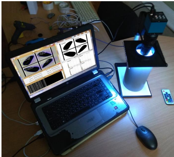
Рис. 1. Конструктивна схема (а) і загальний вигляд (б) експериментального пристрою для автоматичного фенотипування насіння: 1 – відеокамера Video Microscope Camera 1080P 16MP HDMI USB виробництва Eakins; 2 – набори світлодіодів трьох типів (червоний, зелений, синій); 3 – персональний комп’ютер; 4 – захисний екран; 5 – насіння.
