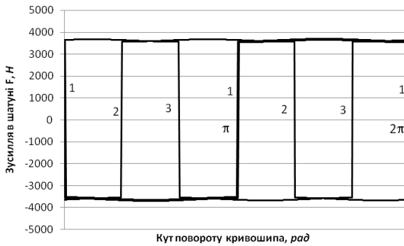
Рис. 5. Графік зміни зусиль в шатунах F_1 (1), F_2 (2) та F_3 (3) в залежності від кута повороту кривошипів.
