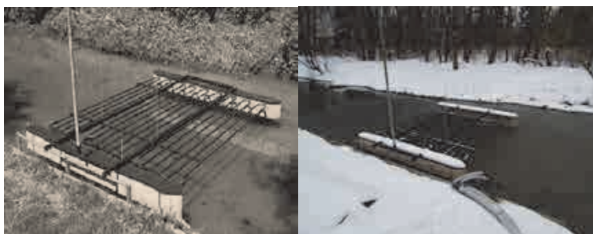
Рис. 8. Фотографии теплообменника для отбора тепловой энергии от водотока
