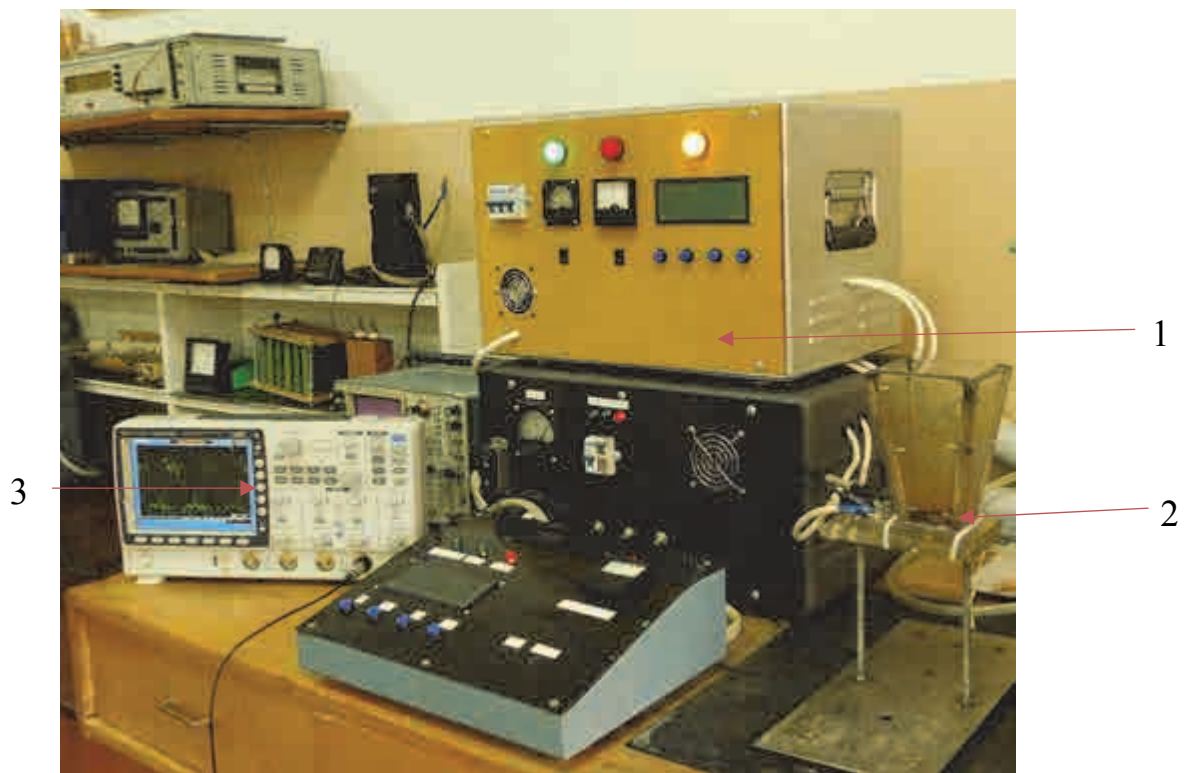
Рис. 1. Електротехнічний комплекс отримання нано- і мікропорошків металів:
