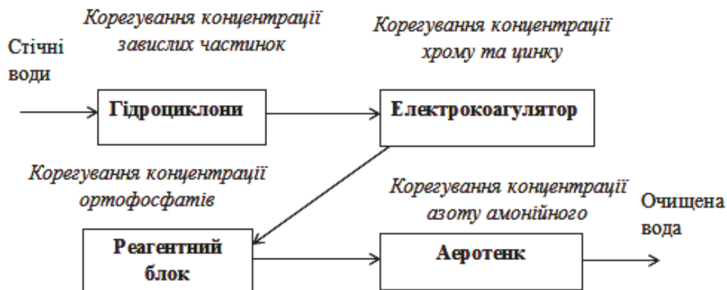
Рис. 1. Варіант загальної структурної схеми використання комбінованих способів очистки стічних вод промислових об'єктів
