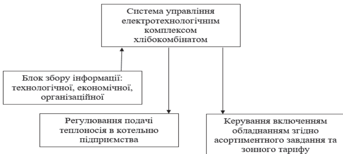
Рис. 1. Схема функціонування системи управління електротехнологічним комплексом хлібокомбінату
