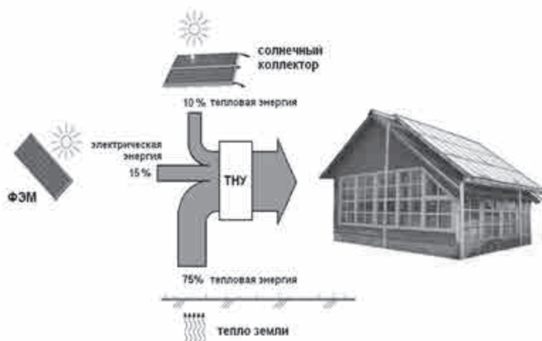
Рис. 2. Поток низкопотенциальной теплоты в системе солнечно-геотермального теплоснабжения
