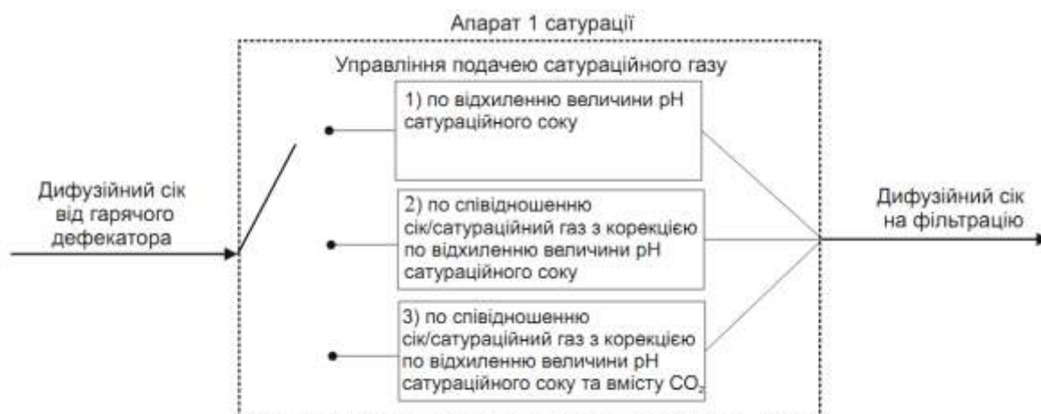
Рис 4. Вибір регулювання подачі сатураційного газу в 1 сатуратор
