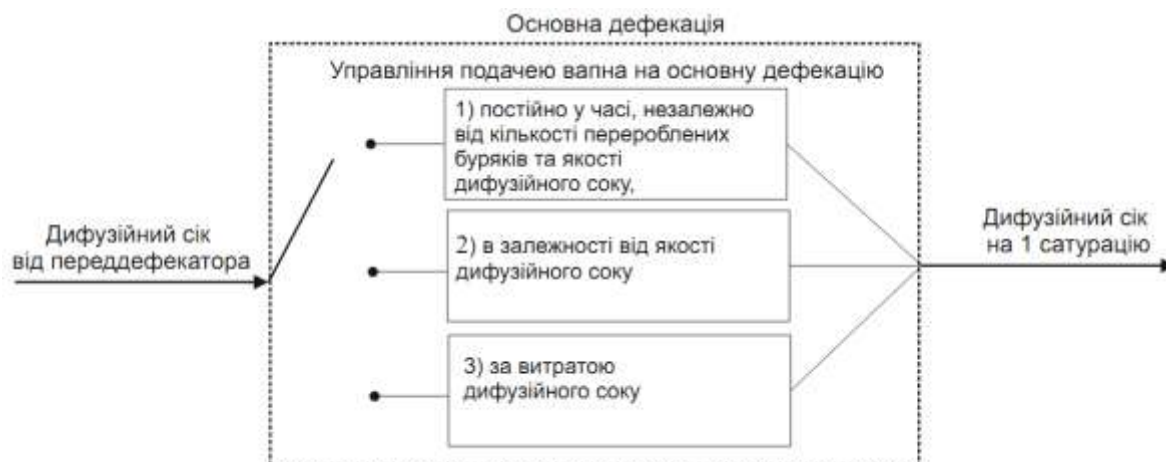
Рис 3. Вибір регулювання подачі вапна на основну дефекацію
