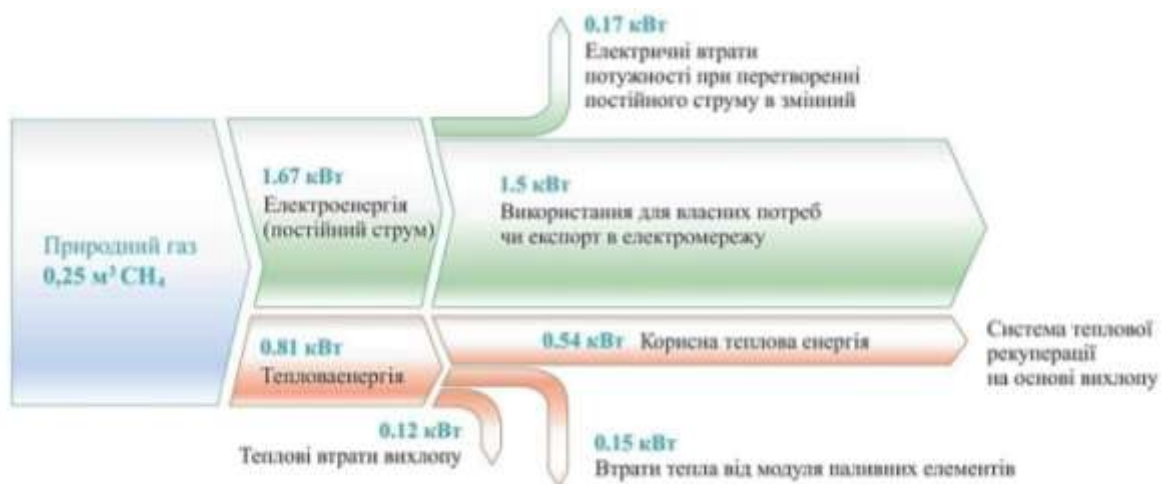
Рис. 2. Енергетичний баланс ринкової установки BlueGEN на базі ТОПЕ потужністю 1,5\text{ kWt}
