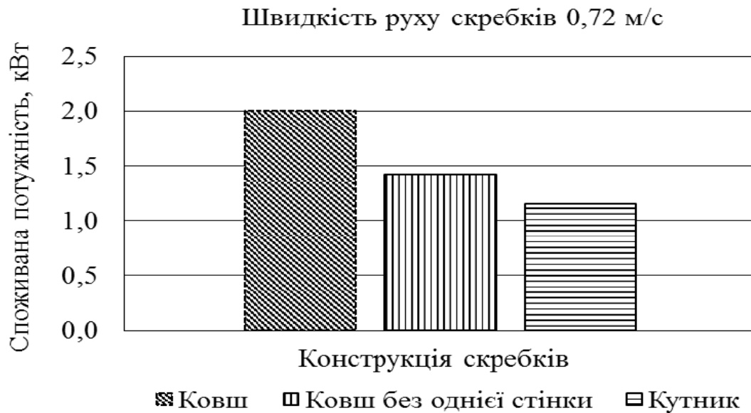
Рис. 2. Залежність споживаної потужності від конструкції розроблених скребків.
