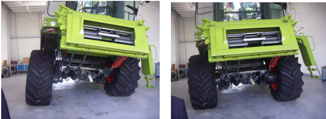
Рис. 1. Система вирівнювання збиральних машин фірми Claas дозволяє за лічені секунди перевести машину з одного в інше крайнє положення.
