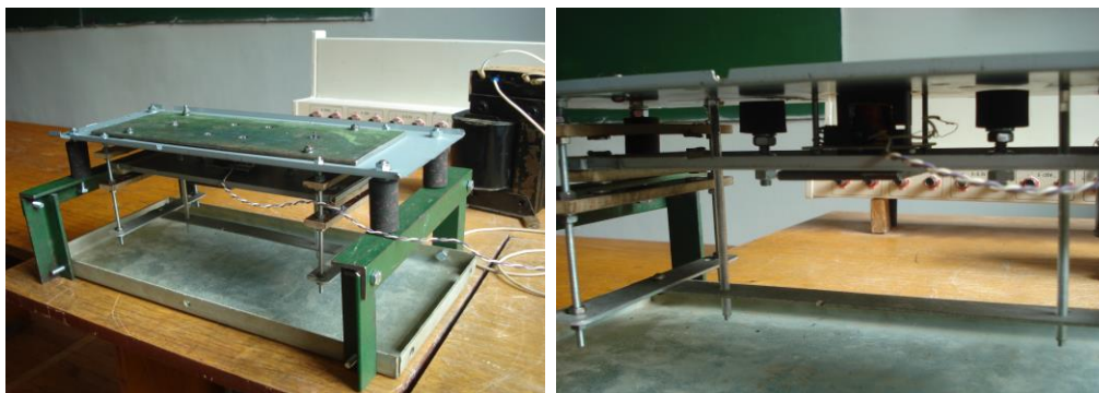
Рис. 10. Лабораторна двомасова електромагнітна ударно-вібраційна установка зі зміненою конструкцією підвіски ударника.
