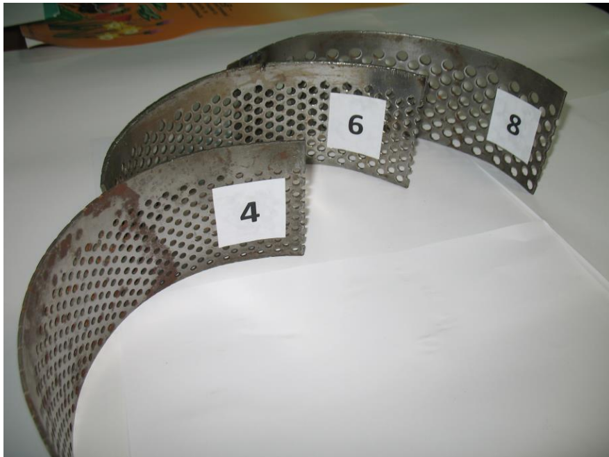
Рис. 1. Загальний вигляд змінних каліброваних решіток: 4 – решето діаметром 4 мм; 6 – решето діаметром 6мм; 8 – решето діаметром 8 мм.
