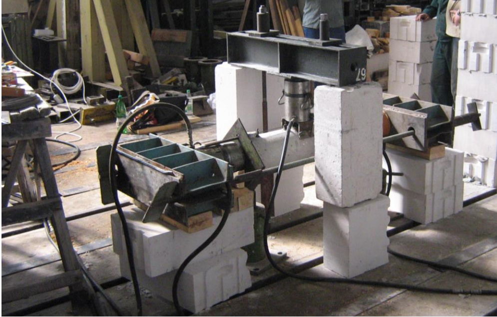
Рис. 1. Установка для проведення випробувань колон з попередніми обтисненням.
