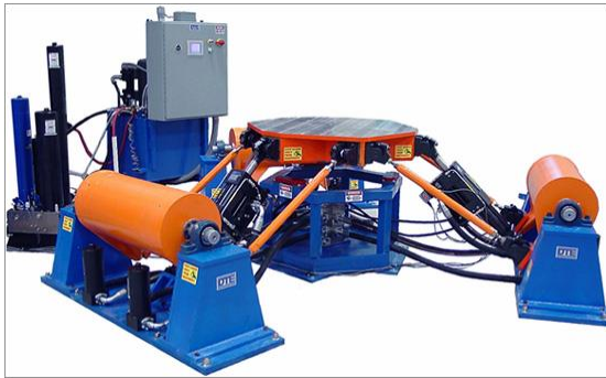
Рис. 3. Вібраційна установка фірми DTE (США): Діапазон частот – низькі, середні, високі; кількість ступеней вільності – 3; тип приводу – гідравлічний сервопривод; комп'ютерна система управління режимом коливань.
