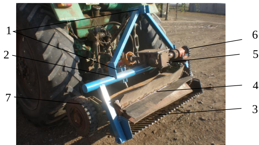
Рис. 3. Експериментальна установка: 1 – навісний пристрій; 2 – рама; 3 – викопуючі робочі органи (набір доліт); 4 – бітер; 5 – редуктор; 6 – привід; 7 – опорне колесо.
