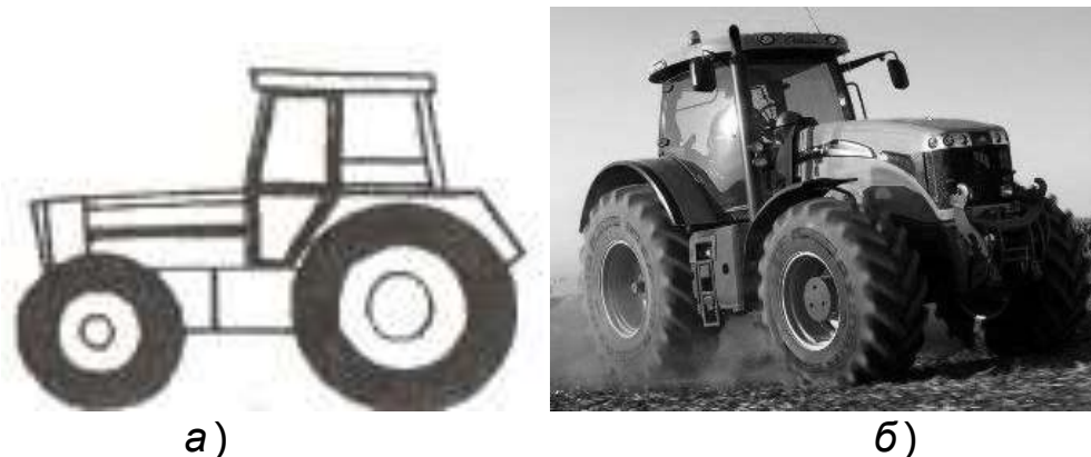
Рис. 2. Покращена класична конструктивно-компонувальна схема МЕЗ: а – принципова схема , б – загальний вигляд.
