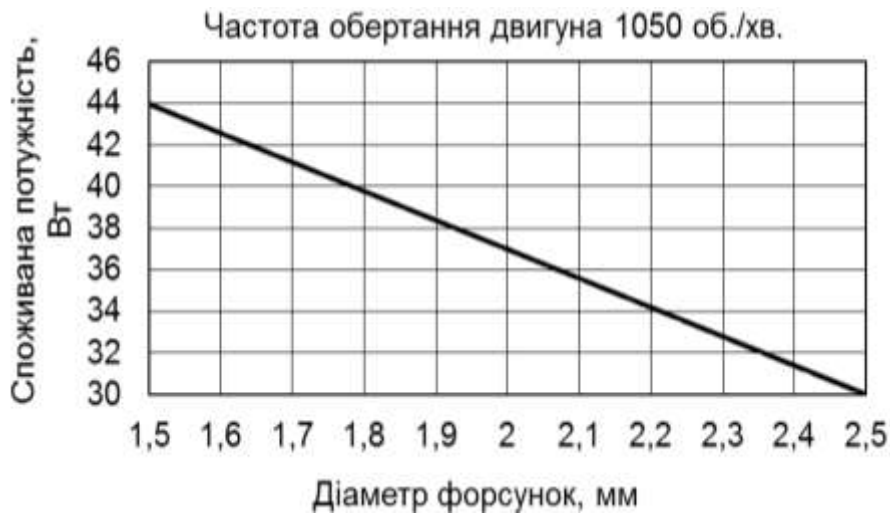
Рис. 4. Залежність споживаної потужності насоса від діаметра форсунок.
