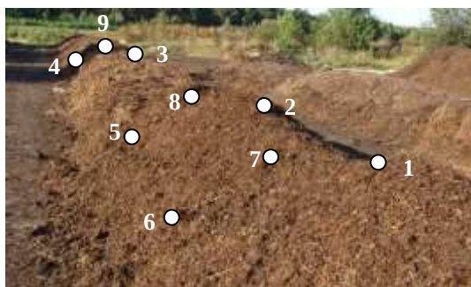
Рис. 1. Загальний вигляд буртів і схема точок вимірювання температури.
