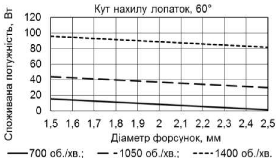
Рис. 1. Залежність споживаної потужності насоса від діаметра форсунок.
