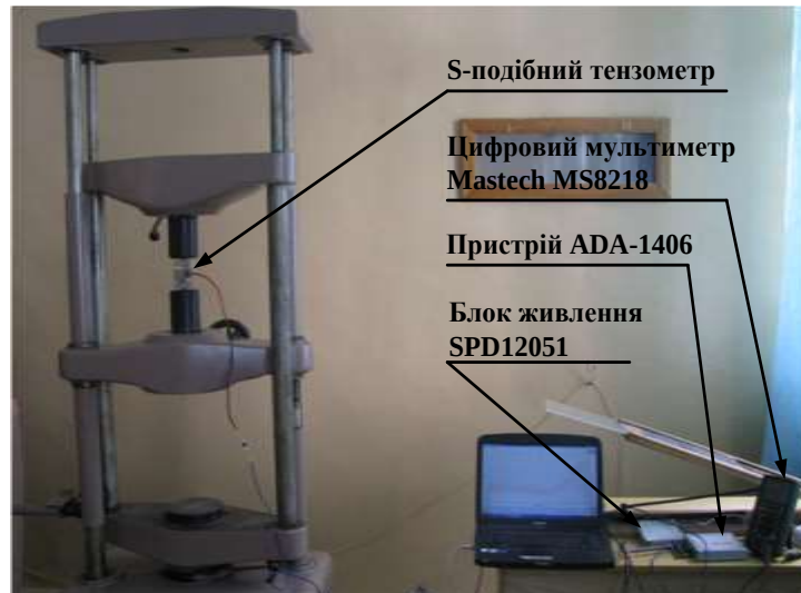
Рис. 6. Тарування датчика зусилля.
