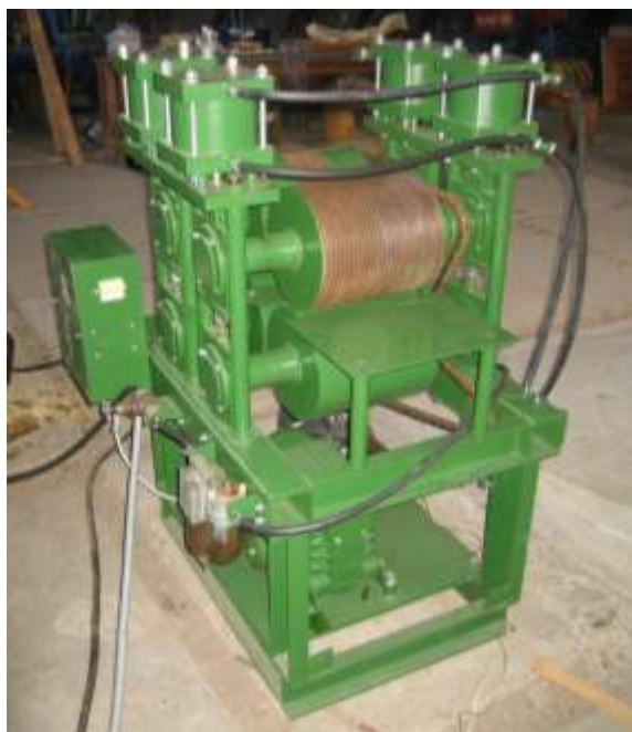
Рис. 1. Установка для роздавлювання деревини.
