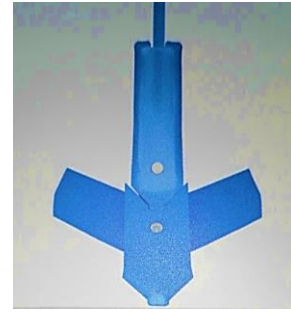
Рис. 2. Форма робочого органу культиватора. Fig. 2. The shape of the working body of the cultivator.
