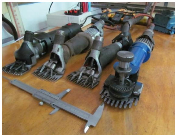
Рис. 3. Досліджувані стригальні машинки: N1J-GM01-76, MSU-200, MCO-77B та стригальна машинка ротаційного типу.
