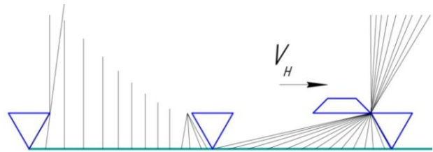
Рис. 2. Процес різання вовни різальною парою з обертотворним характером руху ножа.
